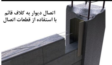
شکل ۵-۱ روش‌های اتصال دیوار به کلاف قائم بتنی
