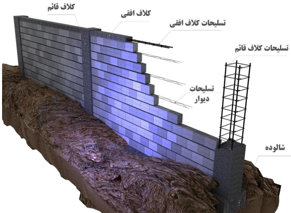
شکل ۱-۲ قسمت‌های اصلی دیوارهای محوطه بنایی
