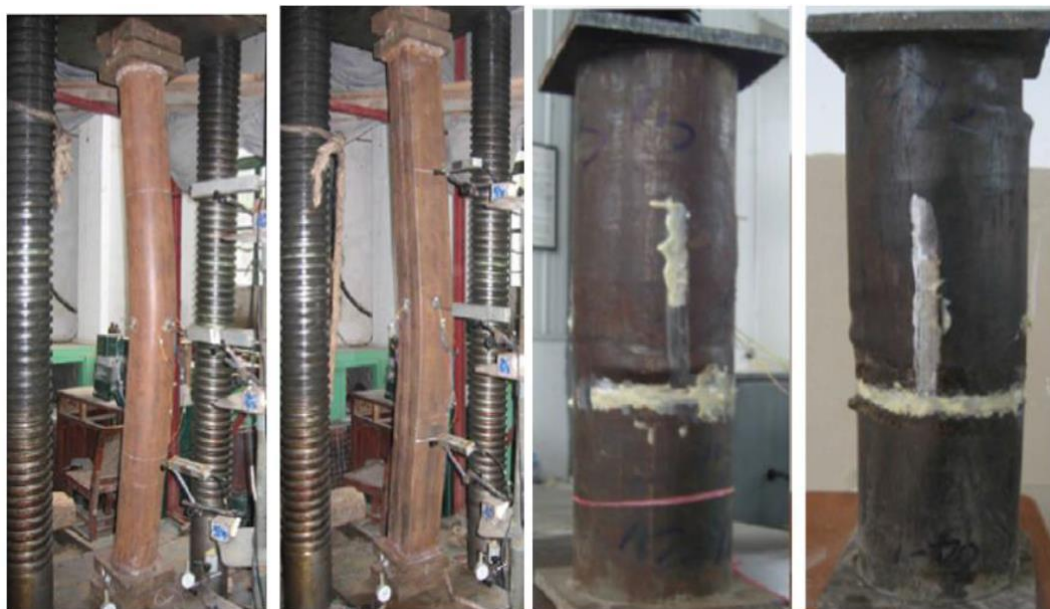
شکل ۲-۲۵، آزمایش بر روی ستون‌های RAC FST [۳۶ و ۳۷]
