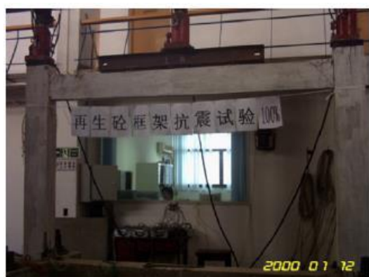
شکل ۲-۳۳، تنظیمات آزمایش بارگذاری چرخه‌ای بر قاب ساخته شده از RAC و منحنی بار-جابه‌جایی در آن [۴۷]
