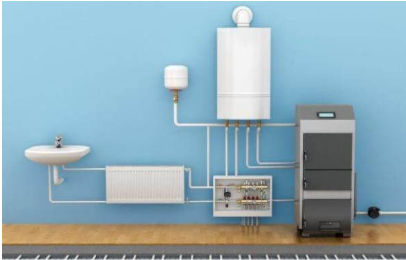
شکل ۲-۹- یک سیستم مستقل شوفاژ واحدها
