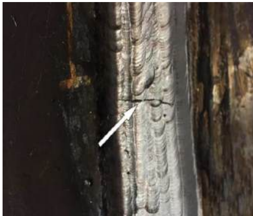
شکل ۱-۲۴- ترک در جوش
