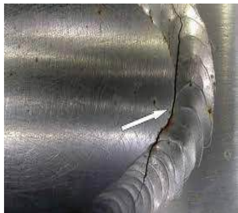
شکل ۱-۲۴- ترک در جوش
