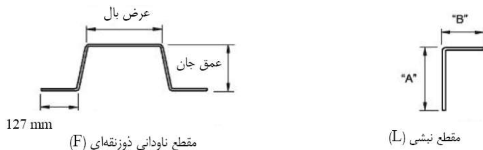
شکل ۲-۱ انواع اعضای موجود در قاب‌بندی‌های فولادی سرد نورد شده
