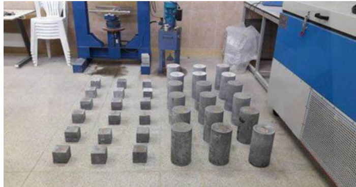
الف) نمونه های استوانه ای و مکعبی بتنی ب) دستگاه انجام آزمایش مقاومت فشاری نمونه بتنی شکل ۳- نمونه های استوانه ای و مکعبی بتن جهت انجام آزمایش فشاری
