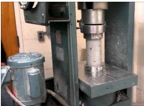
الف) نمونه های استوانه ای و مکعبی بتنی ب) دستگاه انجام آزمایش مقاومت فشاری نمونه بتنی شکل ۳- نمونه های استوانه ای و مکعبی بتن جهت انجام آزمایش فشاری
