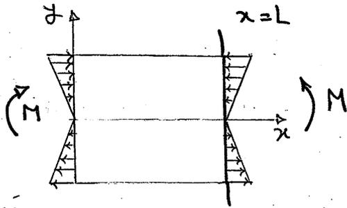
روابط عموماً مربوط به حالت خمشی (Pure bending) می باشد که بر آن تئوری تنش خمشی در ارتفاع مقطع بصورت خطی است.
