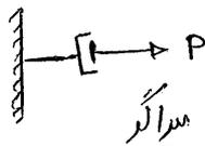
مدل مثل به مدل نیوتن معروف است و برای مواد ویسکوز خطی مناسب می باشد. در تغییر شکل های کوچک مواد در حالت الاستیک از قانون هooke و در حالت ویسکوز از حالت نیوتن پیروی می کنند. در میراگر فوق به بخش برداشتن بار که پس تا قبل برگشت سست دو سطحه باز و ویسکوز الاستیسیتی خزش و وادادگی هستند.
