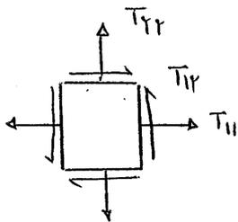
که از بررسی آن تصویر فوایدی می‌توان این دو جهت اصلی را بدست آورد، و جهت اصلی سوز امتداد عمود بر صفحه تنش هستند که بزرگ آن سوز راستی باشد.
