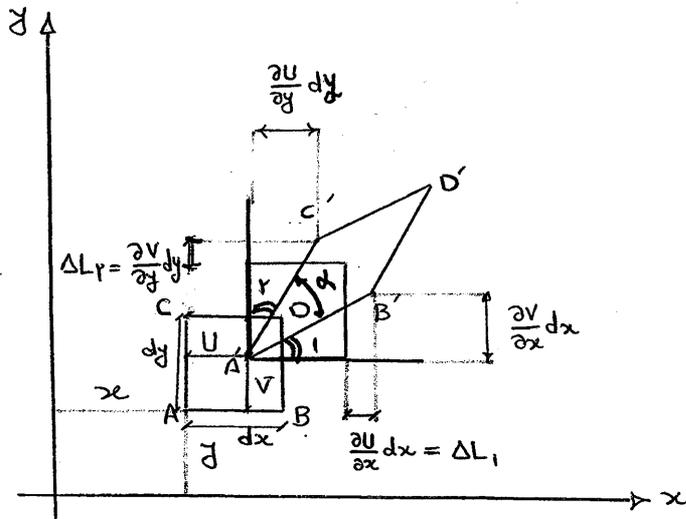
نقطه A در راستای افق به اندازه  $U$  جابجا می‌شود و در راستای عمود به اندازه  $V$  جابجا می‌شود.
