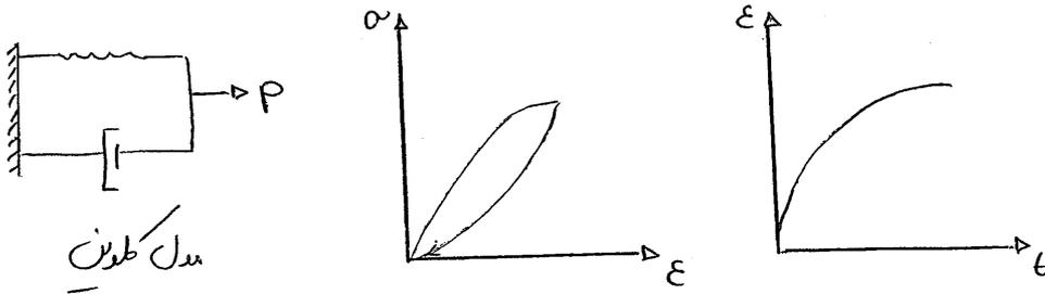
در مدل کولون فنر خطی و سیراگر بصورت موازی بهم متصل شده اند و بنابراین در این مدل کرنش ها یکسان است ولی تنش بین فنر و سیراگر توزیع می شود، در مدل کولون تغییر شکل آنی وجود ندارد. (الاستیسیت خطاری را نشان نمی دهد و مدل سین از باربرداری به موقعیت اولیه خود باز می گردد ولی مسیرهای بارگذاری و باربرداری برهم منطبق نیستند. در مدل کولون تنش امکان رده ابتدا فقط توسط سیراگر تحمل می شود و سپس به مرور به فنر انتقال می یابد و در نهایت تمام بار توسط فنر تحمل می شود.
