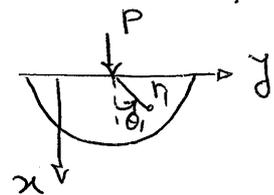
مثال: مطابق شکل زیر نیم صفحه‌ای تحت اثر لنگر مستطی  $M$  در نقطه‌ی  $M$  از میزان قرار دارد بر روی این حالت تابع ایری  $U$  را بیابید.
