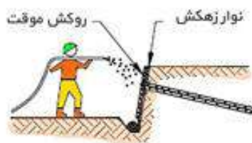
۴- اجرای روکش موقت (شامل نصب شاتکریت، مهره شش گوش، پایت، باربر، واشرا)
