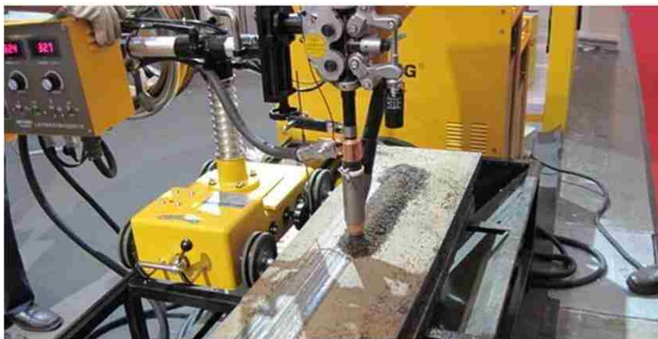
شکل ۱۲-۲- جوشکاری قوسی زیرپودری
