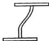
(الف) بال فشاری در مقابل دوران زاویه‌ای نگهداری شده است. (مقطع A-A) (انتقال بدون دوران)
