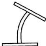
(ب) بال فشاری در مقابل دوران زاویه‌ای نگهداری نشده است. (مقطع A-A) (انتقال با دوران)
