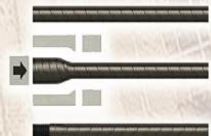
رزوه‌زنی میلگرد به روش اورسایز کردن
