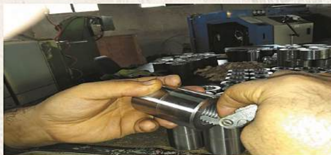
کنترل گام کوپلر آرماتوربندی با گام‌سنج
