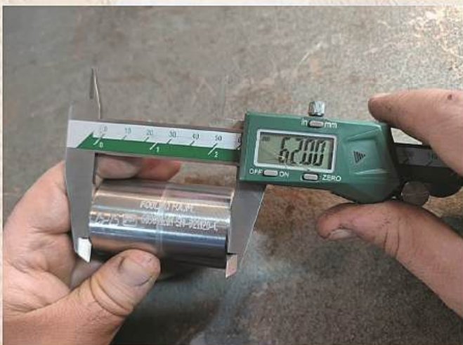
اندازه‌گیری ابعاد کوپلر آرماتوربندی
