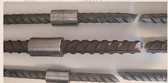
لاشه نمونه ها بعد از تست کشش
