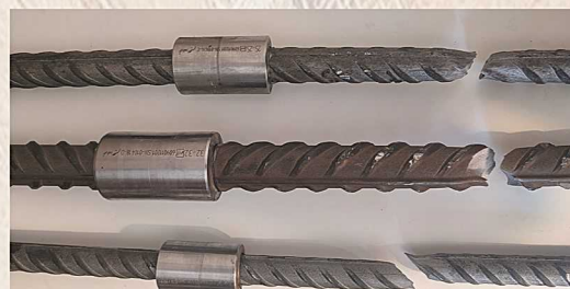
لاشه نمونه ها بعد از تست کشش
