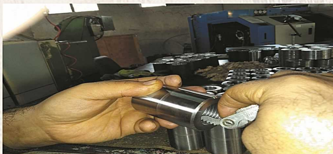
کنترل گام کوپلر آرماتوربندی با گام‌سنج
