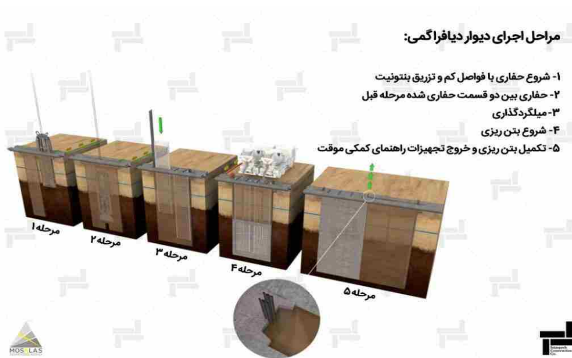
شکل ۴-۱۱- مراحل اجرای دیوار دیافراگمی
