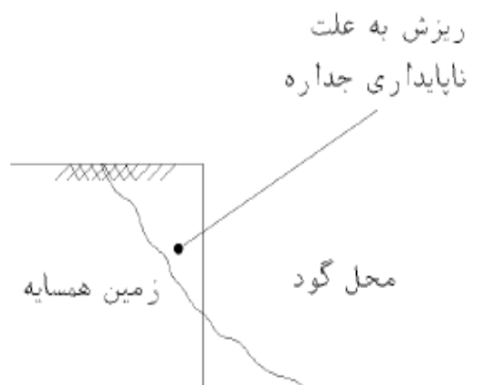
شکل ۱-۲- ریش جداره گود به علت ناپایداری
