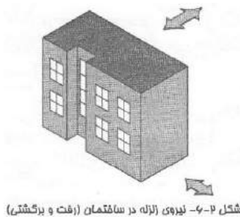
شکل ۶-۴- نیروی زلزله در ساختمان (رفت و برگشتی)
