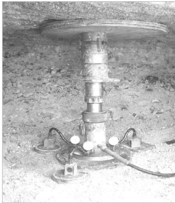
شکل (۶-۷): نمونه‌ای از انجام آزمایش بارگذاری صفحه در گالری در جنوب تهران
