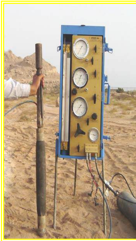
شکل (۶-۱۰): پرسیومتر منارد
