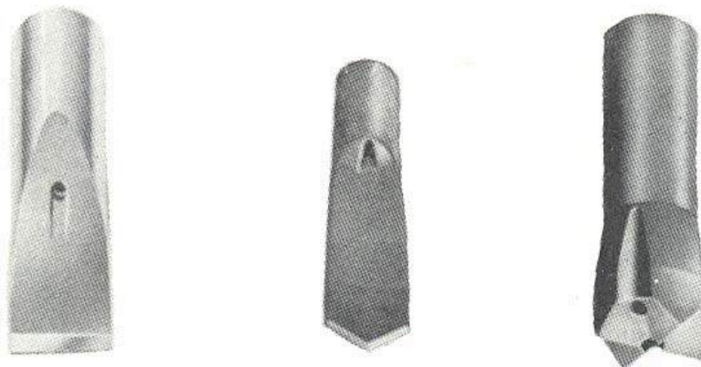
شکل (۳-۱۰): انواع سرمته در حفاری شستشویی (از چپ به راست: تخت، اسکنه ای و ضربدری)
