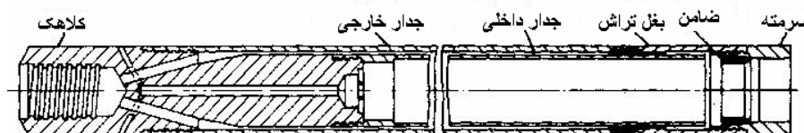
شکل (۴-۱۲): اجزاء کربارل دوجداره صلب
