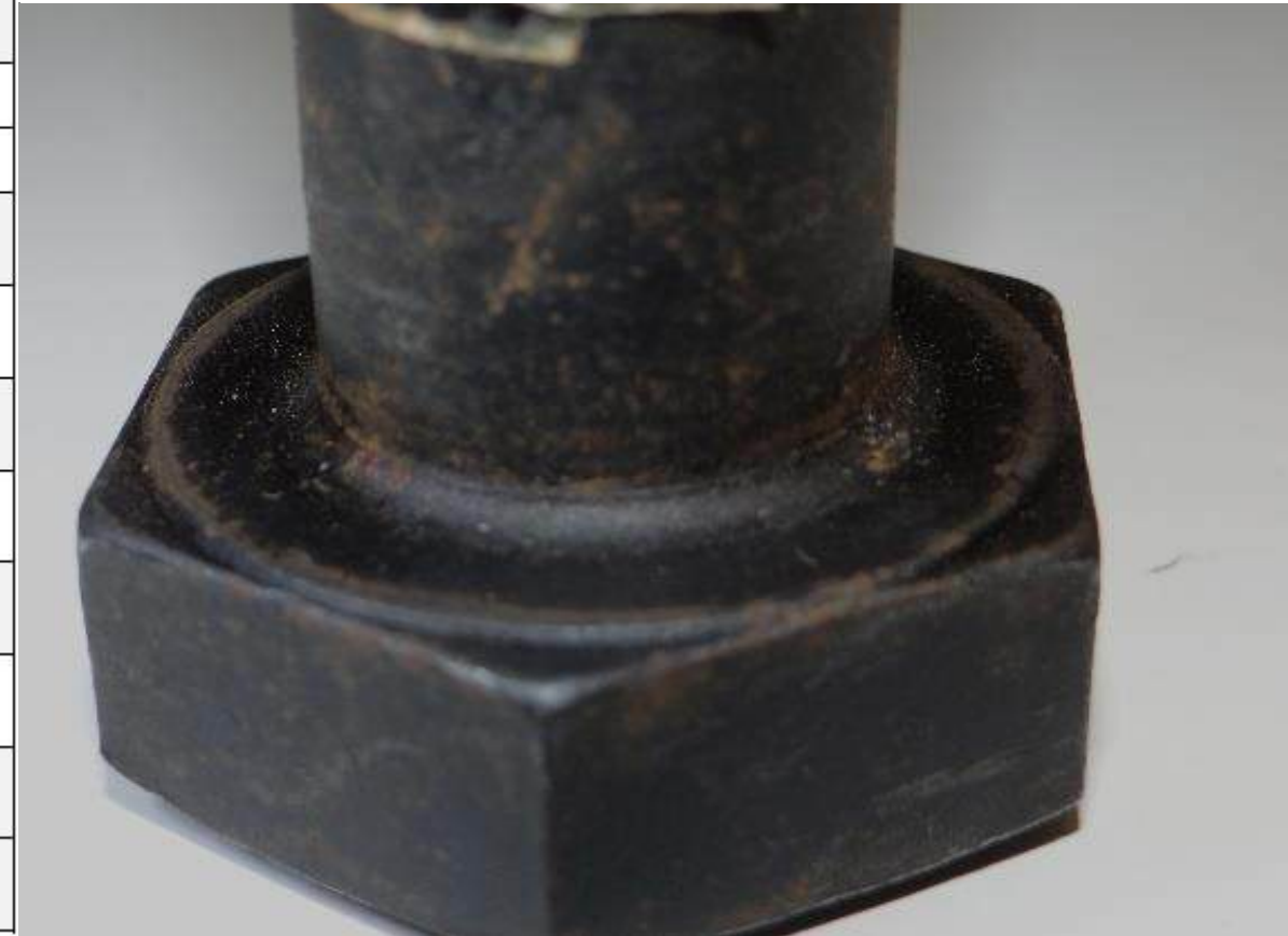
شکل (۷) - شعاع خم کله پیچ
