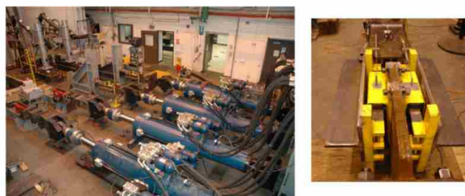
شکل ۳۷-۶ میراگرهای الاستومری-اصطکاکی تحت آزمایش [۲۷].
