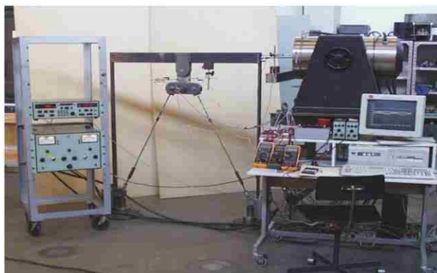
شکل ۳۳-۶ نصب قاب یک طبقه مجهز به میراگر FDD در آزمایشگاه [۲۵].
