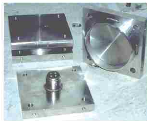
شکل ۱-۱۳ نمایشی از جداگر پاندولی اصطکاکی [۲].
