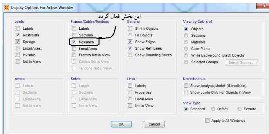
شکل ۶-۷۱ نحوه نمایش مفاصل خمشی در نرم‌افزار SAP
