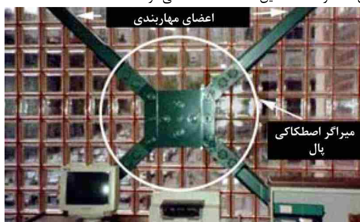
شکل ۴۹-۶ میراگر اصطکاکی پال مناسب برای مهاربند X شکل [۳].
