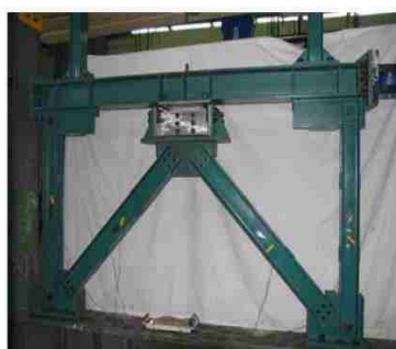
شکل ۴۲-۶ قاب حاوی میراگر FSBD تحت آزمایش [۲۴].
