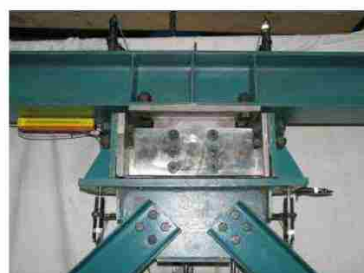
شکل ۴۲-۶ قاب حاوی میراگر FSBD تحت آزمایش [۲۴].
