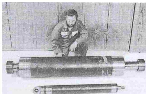
شکل ۵۳-۷ انواع میراگرهای LED قدیمی با ابعاد حجیم، ظرفیت میراگرها ۱۰۰ و ۷۰۰ کیلونیوتن [۴۶].
