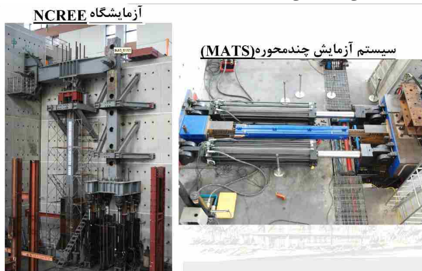
شکل ۷-۲۴/آزمایش چند محوری روی مهارندهای کمانش‌تاب، NCERR/۳۹.
