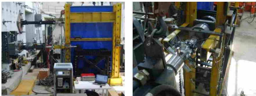
شکل ۵۰-۷ قرارگیری قاب حاوی میراگر LED تحت آزمایش [۴۵].
