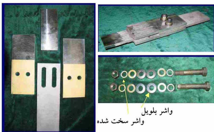
شکل ۶-۲۷ جزئیات میراگر SBC پیش از انجام آزمایش [۲۴].
