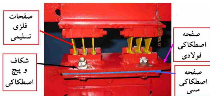
شکل ۷-۷۶ جزئیات سازنده‌ی میراگر MYFD
