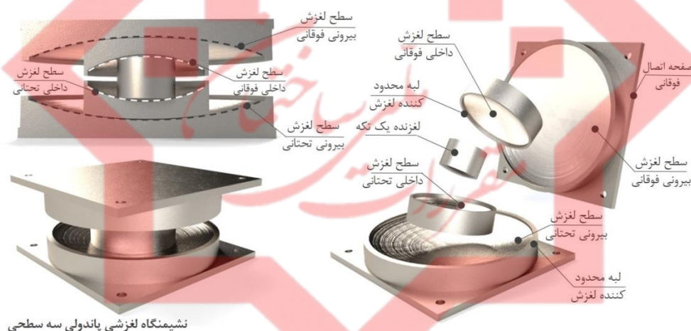
شکل (۲۱-۳). جزئیات نمونه‌ای از نشیمنگاه‌های لغزشی سه پاندولی
