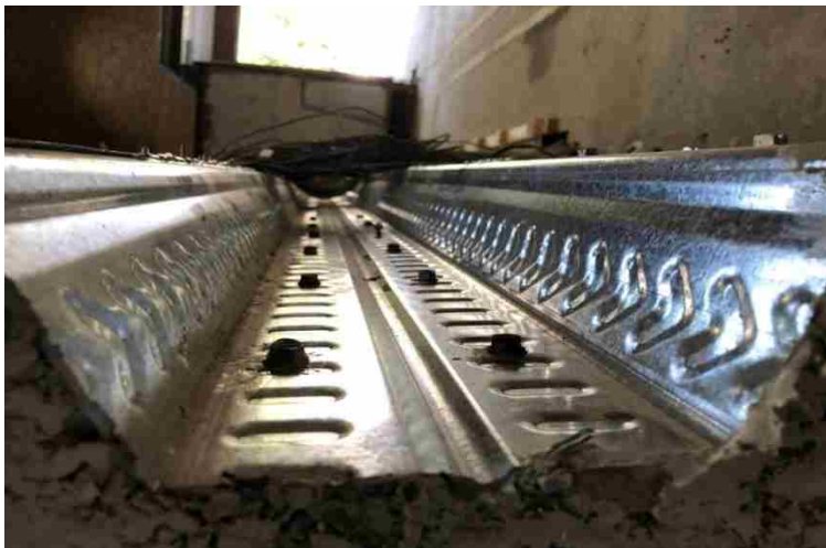
شکل ۳-۷- استفاده از برش‌گیرهای پیچی و محل دقیق تعبیه آنها در نمونه دال‌ها
