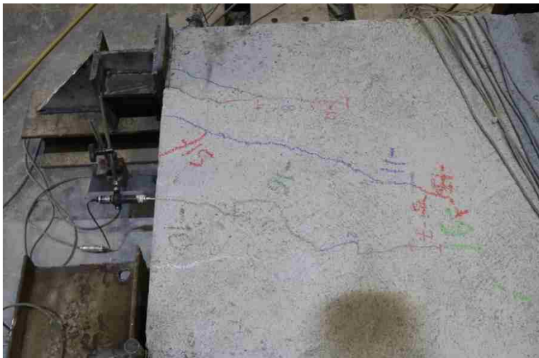
شکل شماره ۵-۵۲ - ترک‌های برشی ایجاد شده در نزدیکی تکیه‌گاه
