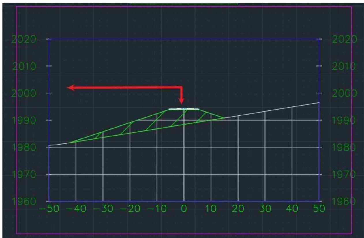
شکل (۷۵). یکنواخت بودن شیب خاکریزی با شیب زمین خاک ریزی قبل از اصلاح
