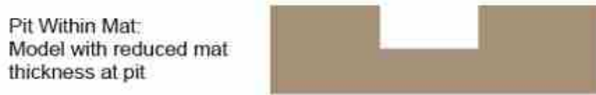
شکل ۲-۱۳: مقطع مدل شالوده در حالتی که کف چاله و شالوده هم‌تراز باشند
