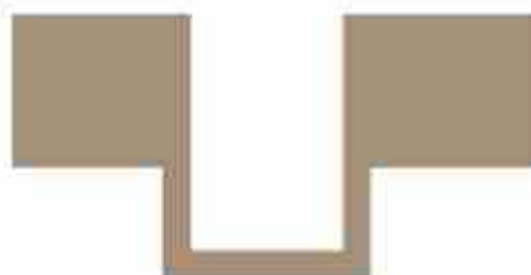
شکل ۴-۱۳: مقطع مدل شالوده در حالتی که شالوده‌ها اختلاف تراز داشته باشند
